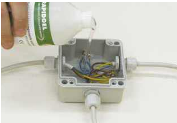
Attendere 15 minuti ad una temperatura di 20°C, se la temperatura è inferiore la reticolazione sarà più lenta. Wait 15 minutes at a temperature of 20°C, if the temperature is lower the reticulation will be slower.
